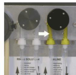
Remplacement par un tube neuf :
