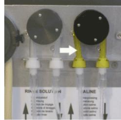
Remplacement par un tube neuf :
