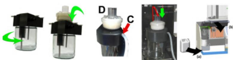
C. Un peu de graisse à base de silicone sur le bord du séparateur facilitera le montage et l'ajustement.
