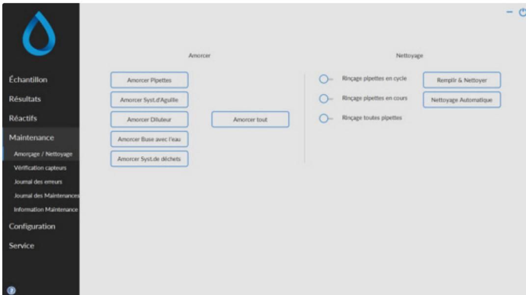
Toutes les fonctions de maintenance pour le système de fluide sont groupées sous le bouton **Amorçage / Nettoyage**.
