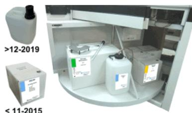
2. Retirer les couvercles à vis du réservoir et extraire les cols des bouteilles hors de la boîte en carton.
